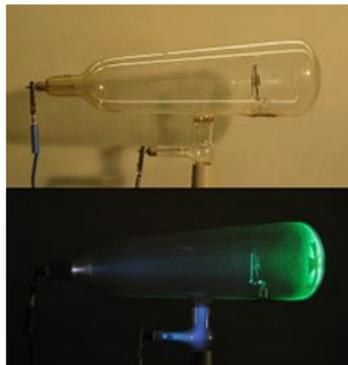
Tube de Crookes, tube cathodique
